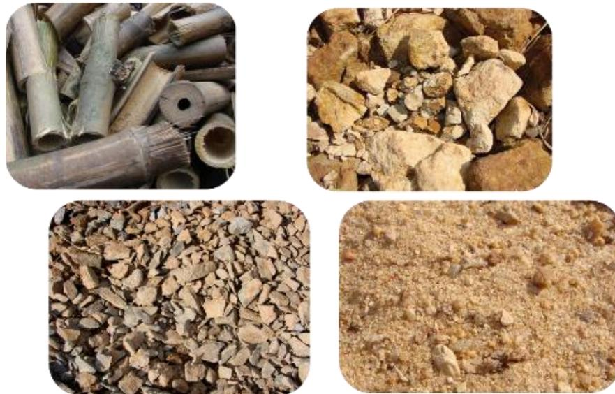
**Figura 6 – Substratos empregados em Wetlands Construídos.**
